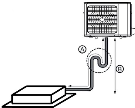
La unidad exterior se carga con refrigerante en fábrica. Cuando la longitud equivalente (5m) se supera, una carga adicional de refrigerante debe añadirse al sistema. Se puede calcular la carga adicional de refrigerante considerando la siguiente fórmula:
