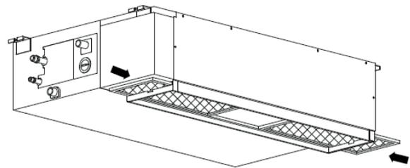
2. Cambiar las posiciones de montaje del panel y brida de retorno de aire.
