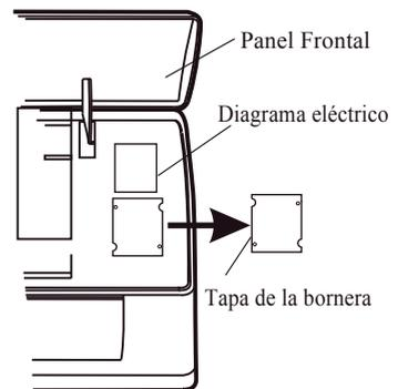
*Nota: Los cables han sido conectados a la placa de la unidad interior por el fabricante de acuerdo al modelo sin utilizar bornera.*
